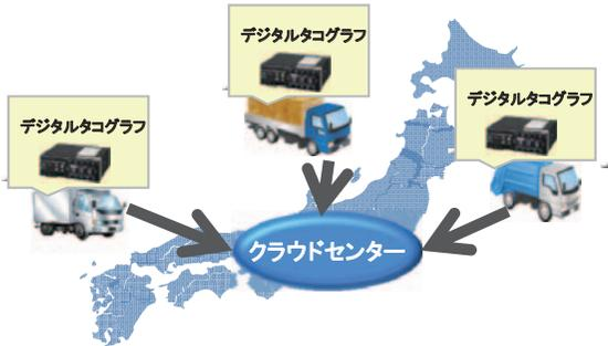
デジタルタコから収集される運行データをクラウドセンターに集約・分析し、運送会社のエコ・安全運転とコスト削減に貢献するサービスを提供致します。
