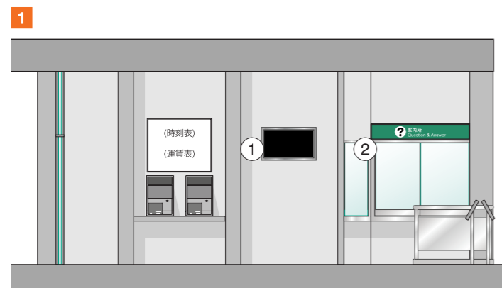
・改札口付近には可変式運行情報表示装置①、案内所位置に案内所位置標②
