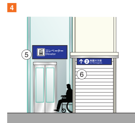
・エレベーター位置にホーム行きエレベーター位置標⑤ ・跨線橋の階段下にホーム誘導標⑥
