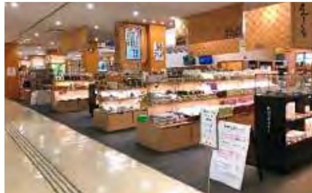
通路空間と店舗空間の路面の色彩・素材を変えることで、視覚的・触覚的に認識できるようにしている。
