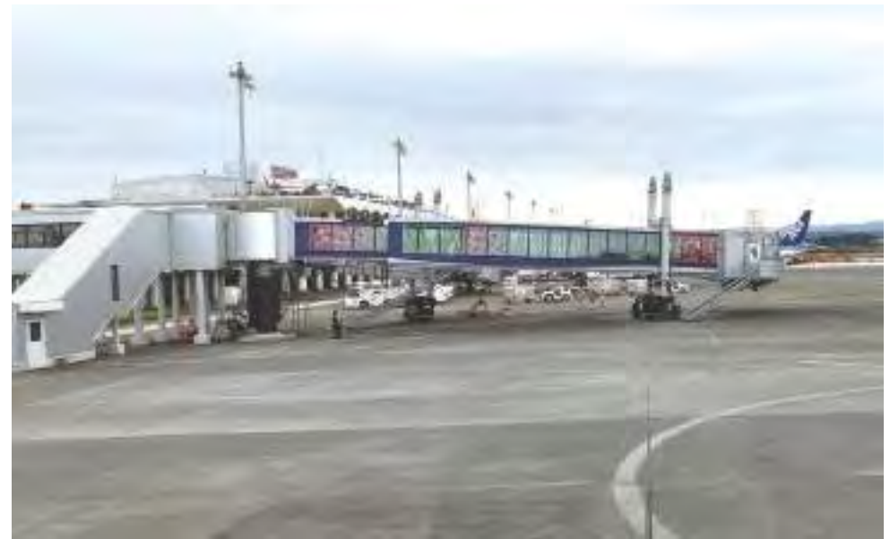
宮崎空港／ロングパッセンジャーボーディングブリッジ
