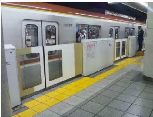
参考 3-1-6 : 可動式ホーム柵（昇降式）の例
