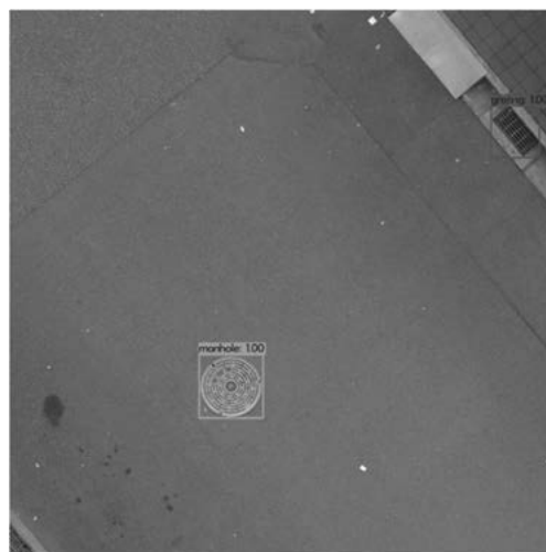
図 6 マンホールとグレーチング検出の様子
