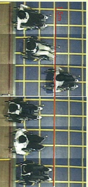
写真3 勾配:1/20、高低差:375mmでの制動距離
