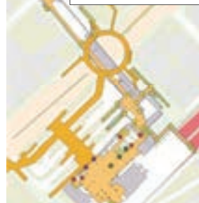
新横浜駅のビーコン配置図(JR新横浜駅2Fと市営地下鉄新横浜駅B1Fを重畳)
