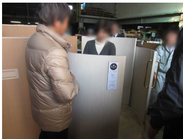
便所内の開閉釦がわかりにくい
