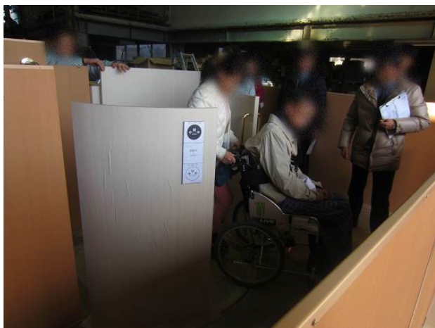
便所内のスペースが広い ため、後ろ向きで 入る
