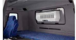
車載バッテリー式冷房装置
