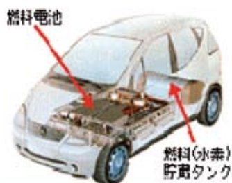
燃料電池自動車の構造
