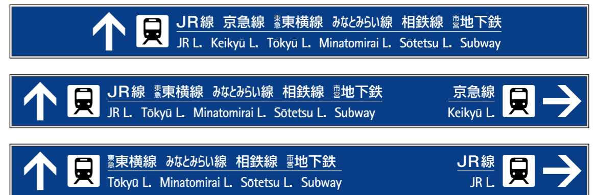
図1.3-14 連続的に設置する鉄道改札口案内標の例
