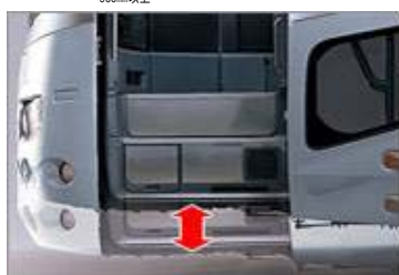
車高を下げ乗降時の段差を解消する乗降口の例
