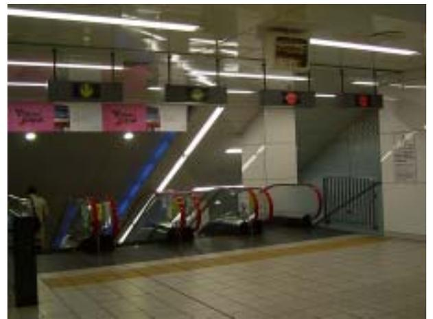
天吊り型のエスカレータ進入方向指示器(2007 画像全体の明るさを加工)。発光ダイオードによる表示の色弁別が困難なだけでなく、輝度が低いため識別の困難も少し発生している。しかし、近付いて表示をよく確認し、同時に踏面の動きを見るなどすれば、容易に進行方向を判断することが可能。
