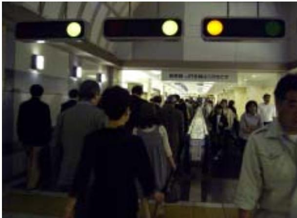
天吊り型の進入方向指示器（2004）。表示に使われている色が弁別できないので、どちらに進入すべきかを判断できない。しかし、この設備においては恒常的に利用客が多いため、人の流れや歩道の動きを見ることによって進行方向を判断すれば、大きな問題は起きない。
