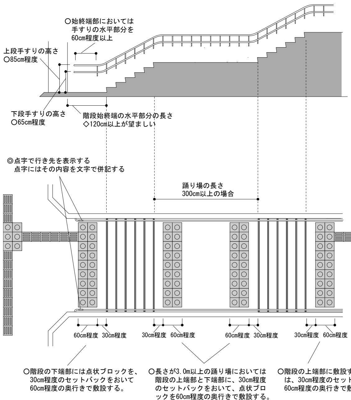
■階段の方向が 90 度・180 度変わる踊り場における点状ブロックの敷設方法例
