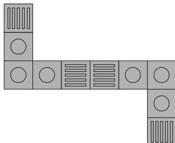
参考 2-2-17：各設備への視覚障害者誘導用ブロックの敷設方法の例
