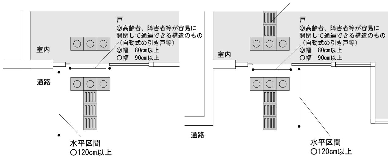
注：通路から出入口を後退させ、窓を設けた例
