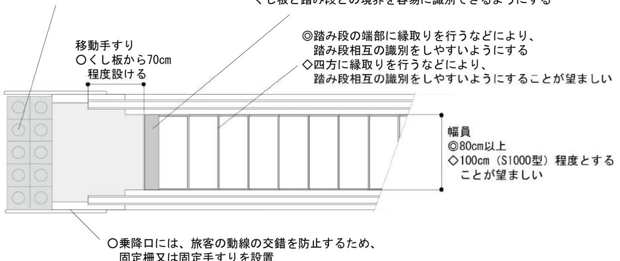
注) 固定柵又は固定手すりの設置にあたっては、エスカレーターとの間隔が狭いと、人や物が巻き込まれる危険性があるため、その取付位置について十分な検討が必要である。なお、モデル図に示すように固定手すりを移動手すりの外側に一部重なるように設置することにより、この危険性を回避できる。
