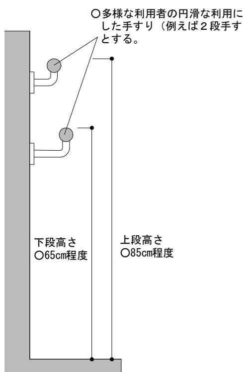
注) 上図は、直棒状の2段手すりを設置した場合の例
