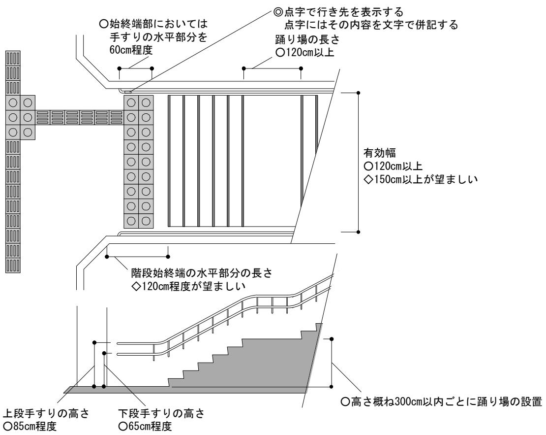
注) 上図は、直棒状の2段手すりを設置した場合の例
