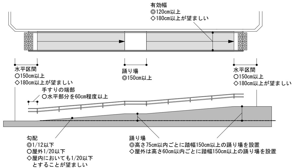
注) 上図は、直棒状の2段手すりを設置した場合の例
