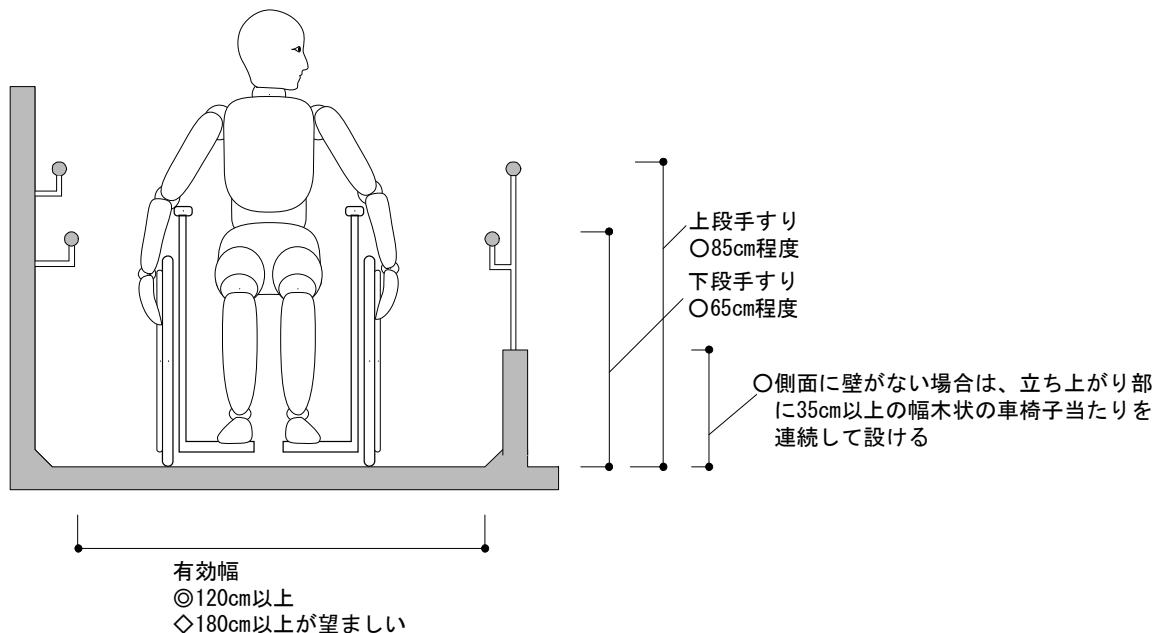
注) 上図は、直棒状の2段手すりを設置した場合の例
