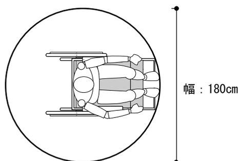
(注意) 手動及び電動車椅子の寸法：全幅 70cm、全長 120cm の場合 (JIS 規格最大寸法)
