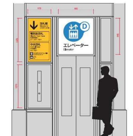
※ガラス面にインクジェット出力シート(UVカットラミネート)直貼
