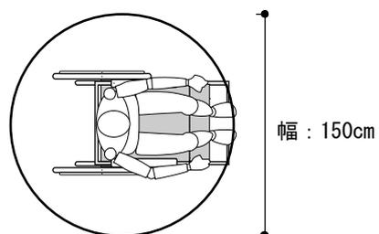
●電動車椅子が360度回転できる最低寸法
