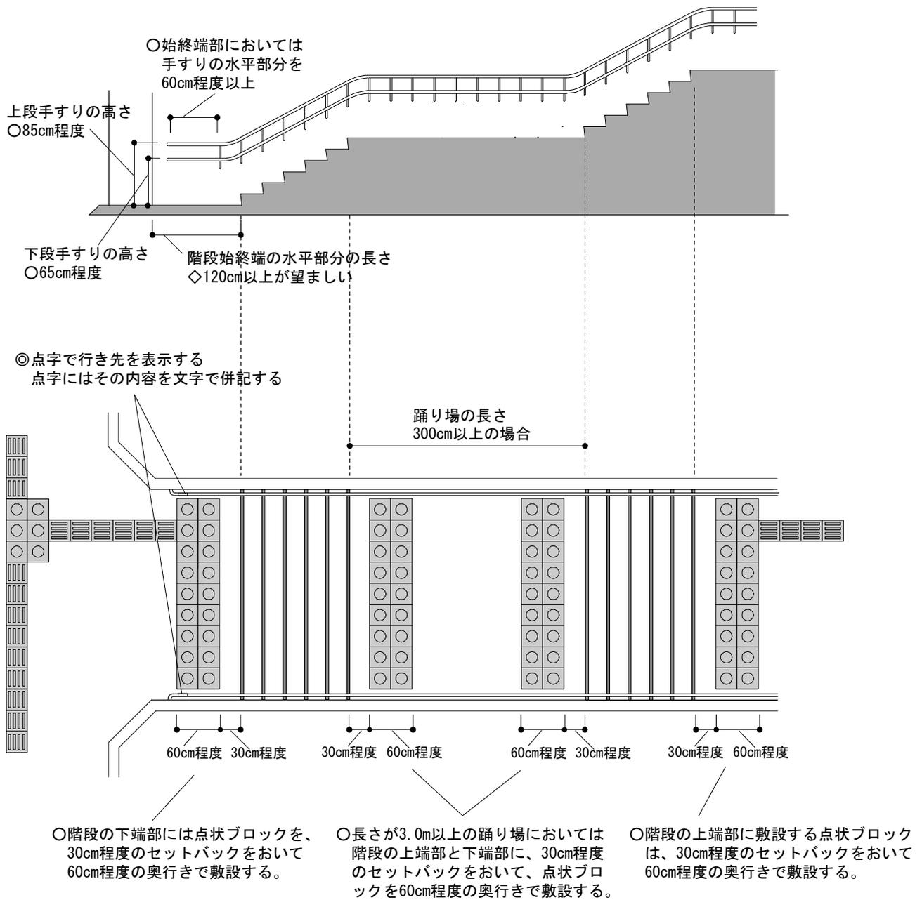
■階段の方向が90度・180度変わる踊り場における点状ブロックの敷設方法例
