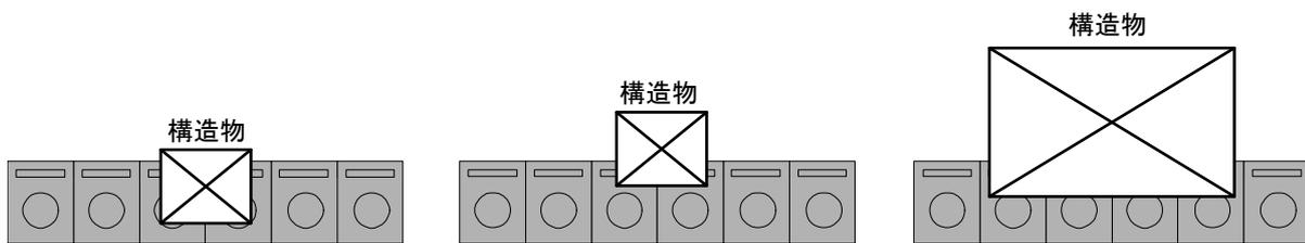
※「公共交通機関旅客施設の移動円滑化整備ガイドライン 追補版」(平成 14 年 12 月)の策定にあたり実施した「コの字迂回敷設部分と連続敷設部分の歩行実験」の結果、被験者の 90%から連続敷設を支持する回答を得たことから、上図の連続敷設方式を採用し、また構造物と衝突した際の安全性を考慮し、柱などの構造物にはクッションなどを設けることが望ましいとしている。このような敷設方法とした理由として、「①迂回すると方向や位置がわからなくなる。」、「②構造物の線路側のブロックが無くなるのは困る。」、「③連続敷設が簡潔で分かりやすい。連続敷設は構造物に触れることができる。触れることで安全を確認する。」、「④ホーム縁端からの距離が一定である。」等の意見があった。
