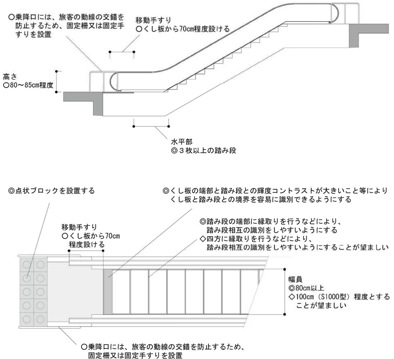
注) 固定柵又は固定手すりの設置にあたっては、エスカレーターとの間隔が狭いと、人や物が巻き込まれる危険性があるため、その取付位置について十分な検討が必要である。なお、モデル図に示すように固定手すりを移動手すりの外側に一部重なるように設置することにより、この危険性を回避できる。
