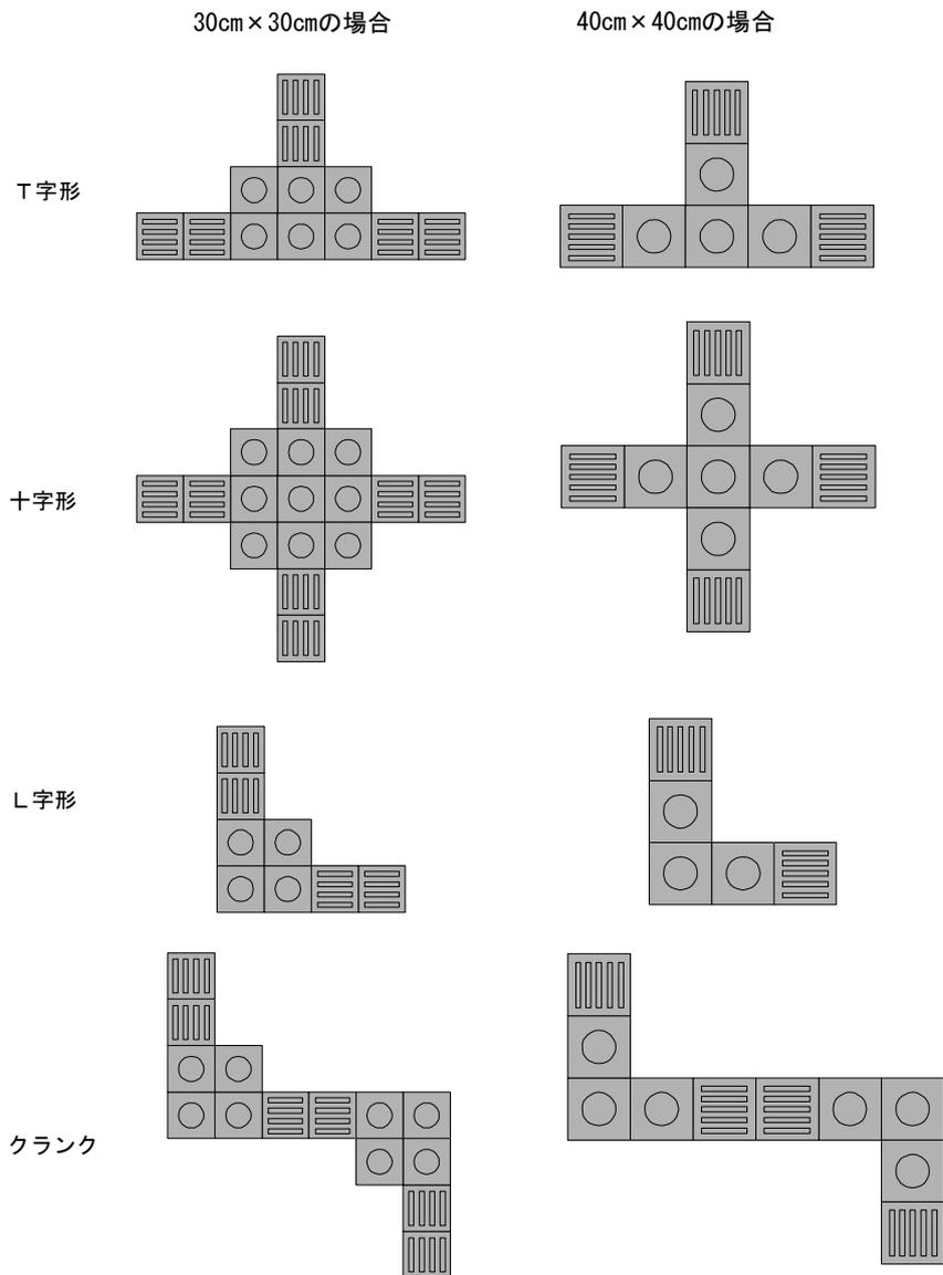
参考 2-2-17 : 各設備への視覚障害者誘導用ブロックの敷設方法の例
