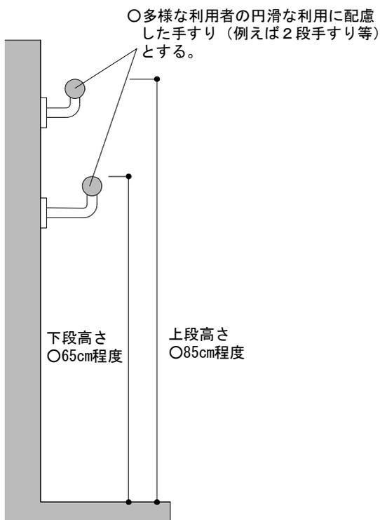
注) 上図は、直棒状の2段手すりを設置した場合の例
