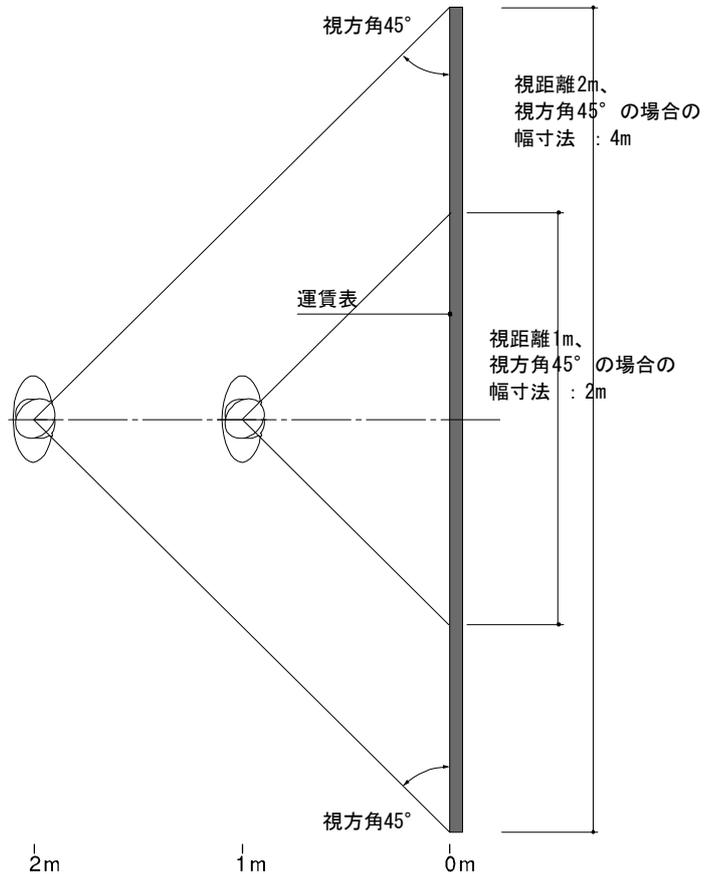
注) 野呂影勇編「図説エルゴノミクス」1990 (日本規格協会) では、監視用グラフィックパネルの鉄労研のデータから、視角度が 45° 以下では表示内容の誤読率が増加して好ましくない、と述べている。
