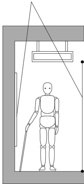
○原則として床から高さ200cm程度の高さまでの間の空間に天井、壁面からの突出物を設けない。
