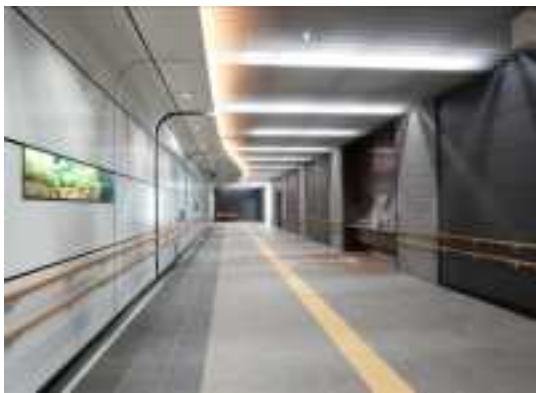
（仙台駅）空間誘導に役立つ照明デザイン
