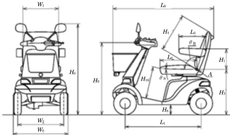
注記 全高 ( $H_0$ ) は、ヘッドサポートを取り外した状態でバックミラーを含め床からの高さが最も高い部位で測る。
