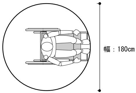
(注意) 手動及び電動車椅子の寸法：全幅 70cm、全長 120cm の場合 (JIS 規格最大寸法)
