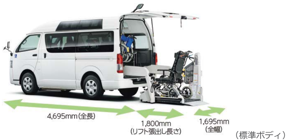
参考 4-3-6：大型電動車椅子・ストレッチャー（寝台）等対応車両の事例
