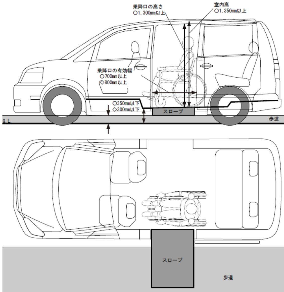
解説：歩道の幅が 2 メートル以上、スロープの長さ 1 メートル以下の場合、側面からの車椅子の乗降が可能。
