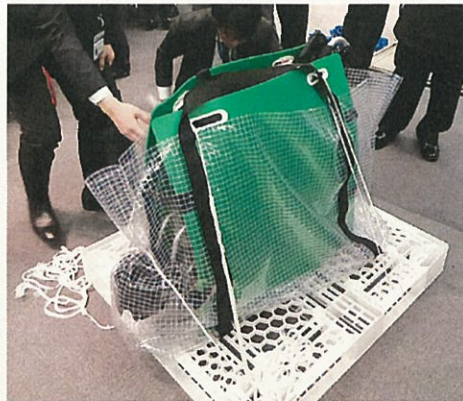
航空機コンテナ用パネルへの取り付け状況
