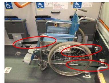
今年度車両より導入した『リトラクター式固定ベルト※』
