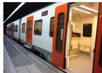
高床式車両においても中間部は低床化して車いす、ベビーカー、自転車に対応するのが今や欧州の主流
