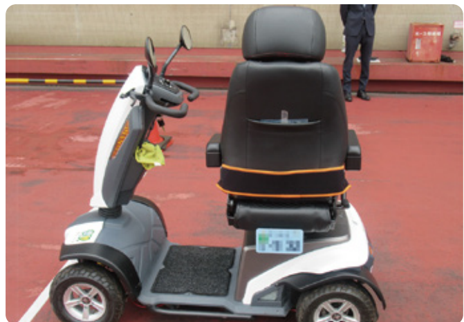
取り付けられたナンバープレート、シートが回転するため乗降がしやすい
