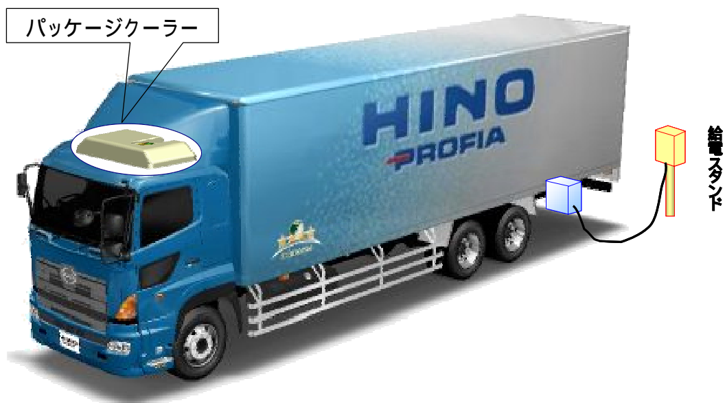
図 II-13 パッケージクーラーと給電スタンドのイメージ
