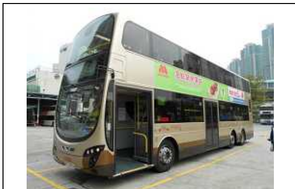
訪問した KMB の 2 階建ローフロアバス (ニーリング機構でバスの床面を下げられる)
