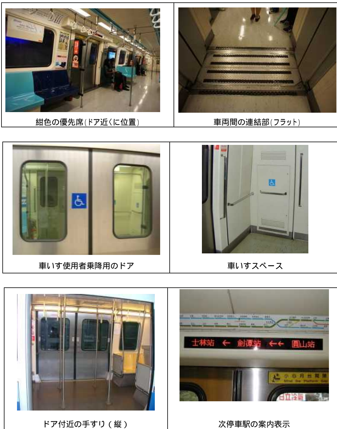
図 2-22 車両内のバリアフリー設備
