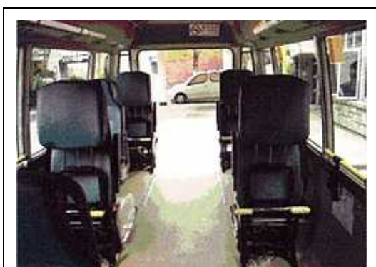
車内の車いすスペース (車いすはフロアレールに固定し、折りたたんだシートをヘッドレストとして使用する。シートは取り外し可能。)
