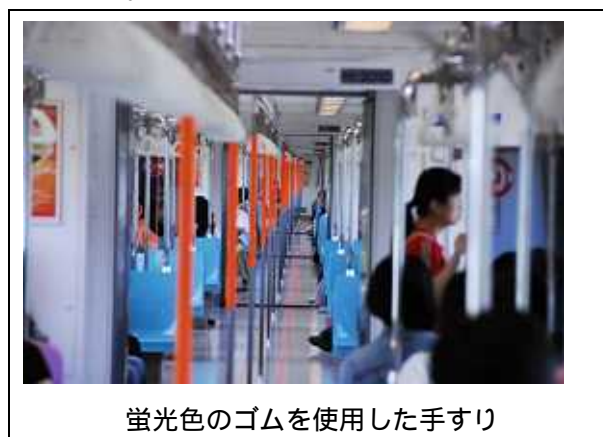
図 2-23 蛍光色の手すり
